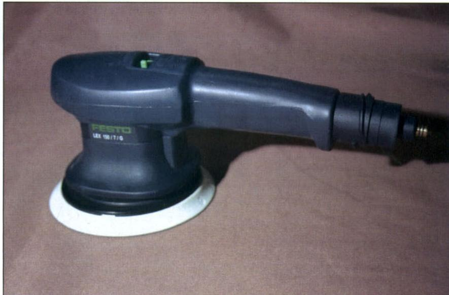
**L**as lijadoras excéntrico-rotativas combinan características de las lijadoras rotativas o radiales y de las vibratorias. Es decir, el plato lijador realiza, a la vez, un movimiento de giro y un movimiento excéntrico.
