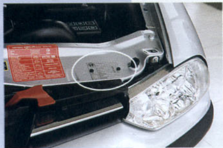
Localización de la placa del constructor
