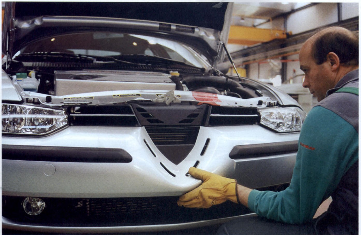
Desmontaje del frente delantero
