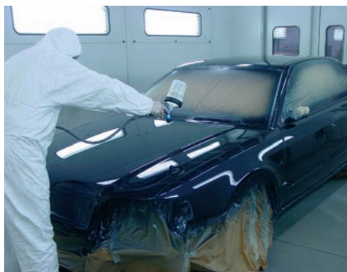
Aplicación de barniz bajo en COV
