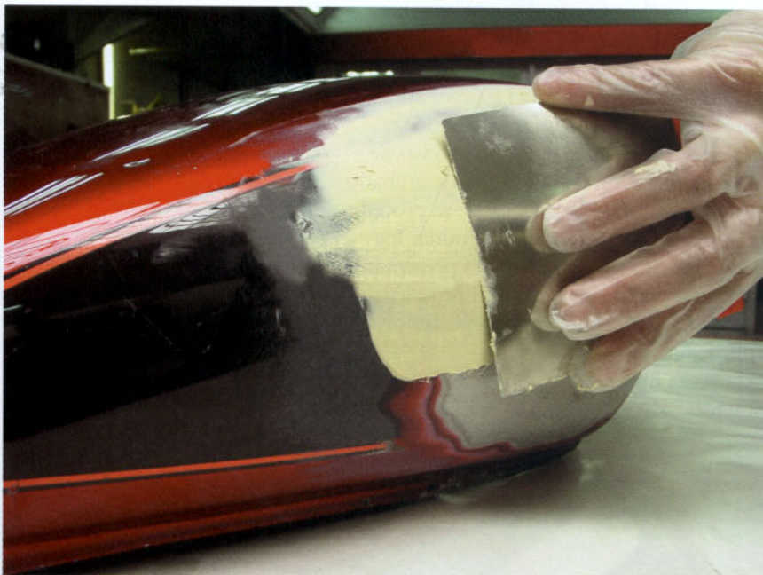
Aplicación de masilla
