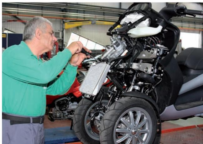
asimismo con tubos de acero, aunque de menor sección. El subchasis soporta los elementos del cuadro, carrocería, radiador y demás accesorios ubicados en la zona delantera de la motocicleta.
