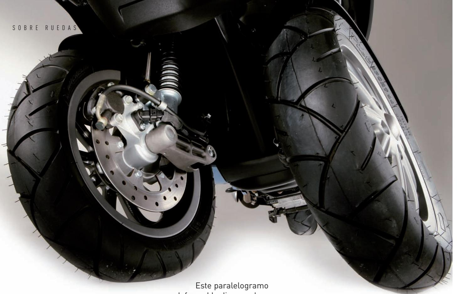
Este paralelogramo deformable dispone de un tubo de dirección para cada rueda delantera, montando en cada lado un sistema de freno y suspensión individualizado.
