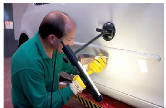
Proceso de reparación mediante pegado
