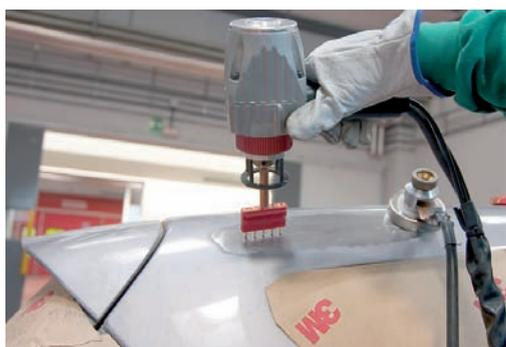
► Proceso de reparación mediante soldadura
