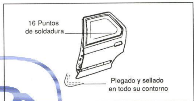
Figura 39.- Unión de la puerta trasera
