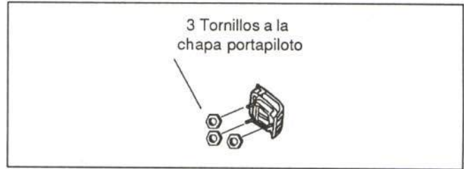
Figura 60.- Sujeción del piloto trasero
