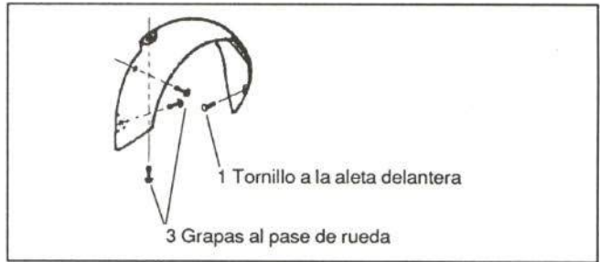
Figura 20.- Sujeción del guardabarros de aleta
