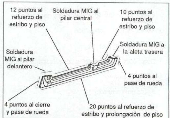
Figura 37.- Unión del estribo
