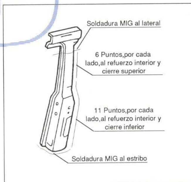
Figura 38.- Unión del pilar central
