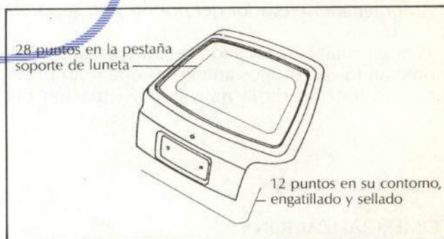
Fig. 65.—Unión del panel al armazón del portón trasero.
