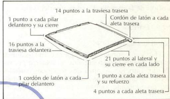
Fig. 48.—Unión del techo a la carrocería.
