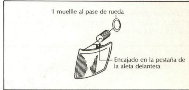
Fig. 13.—Sujeción del piloto.
