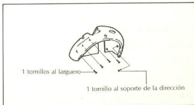
Fig. 26.—Montaje del guardabarros.
