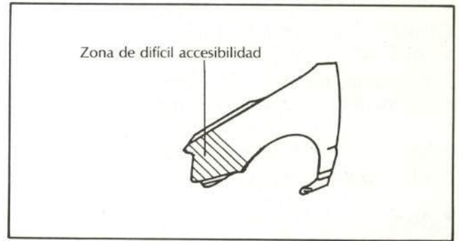
Fig. 21—Accesibilidad de la aleta delantera.
