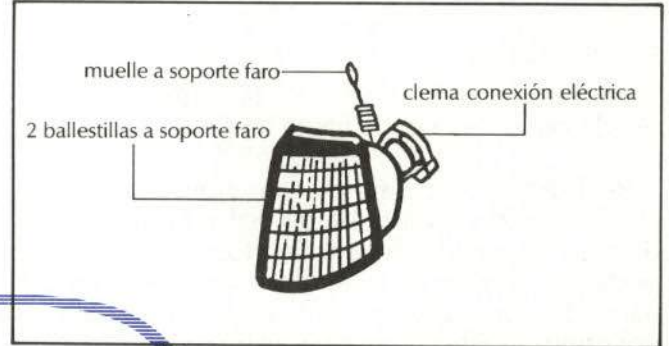
Fig. 10—Fijación del piloto delantero.
