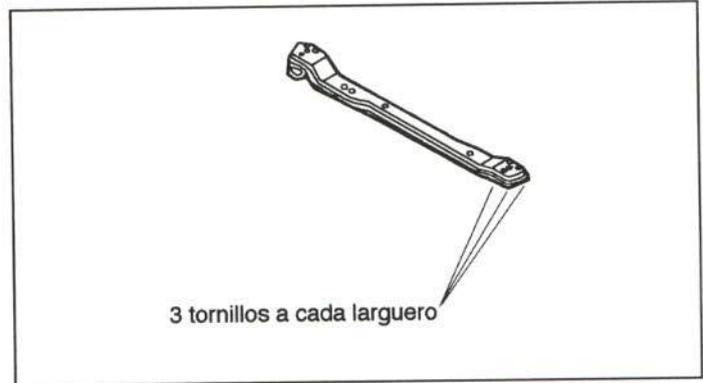
Figura 25.- Unión de la traviesa inferior
