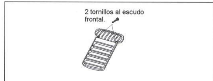
Figura 27.- Unión de la rejilla frontal
