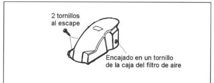
Figura 40.- Unión del guardabarros trasero
