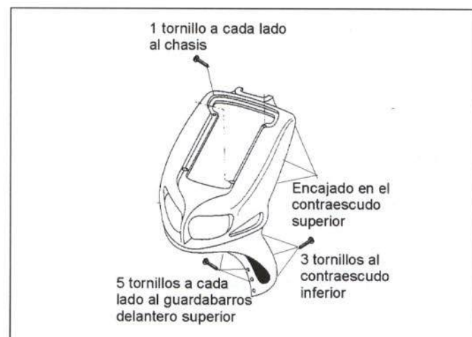
Figura 28.- Unión del escudo frontal
