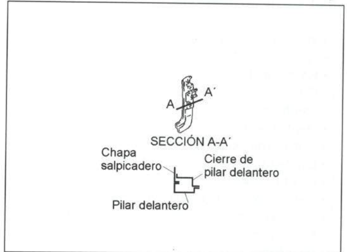
Figura 34.- Accesibilidad del pilar delantero
