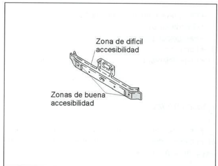
Figura 22.- Accesibilidad de la traviesa inferior
