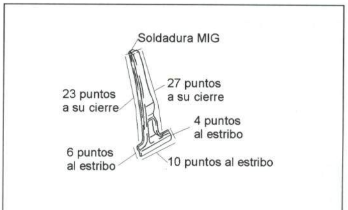
Figura 36.- Unión del pilar central
