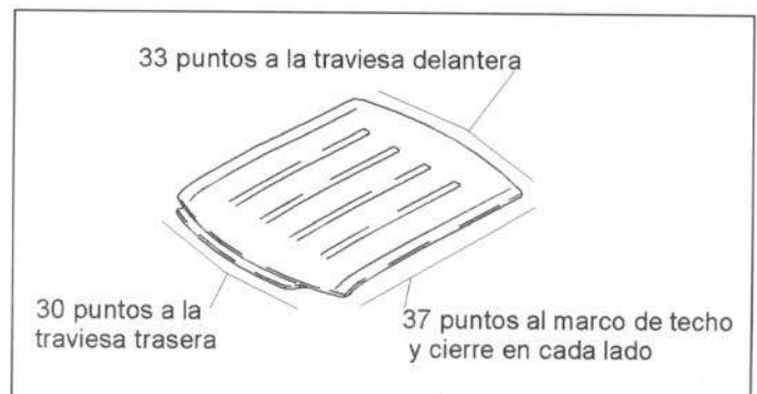
Figura 42.- Unión del techo
