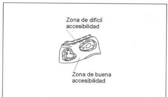
Figura 56.- Accesibilidad del costado trasero
