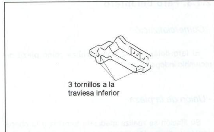
Figura 19.- Unión de la traviesa superior
