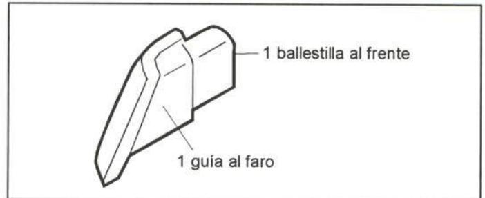
Figura 14.- Unión del piloto de intermitencia
