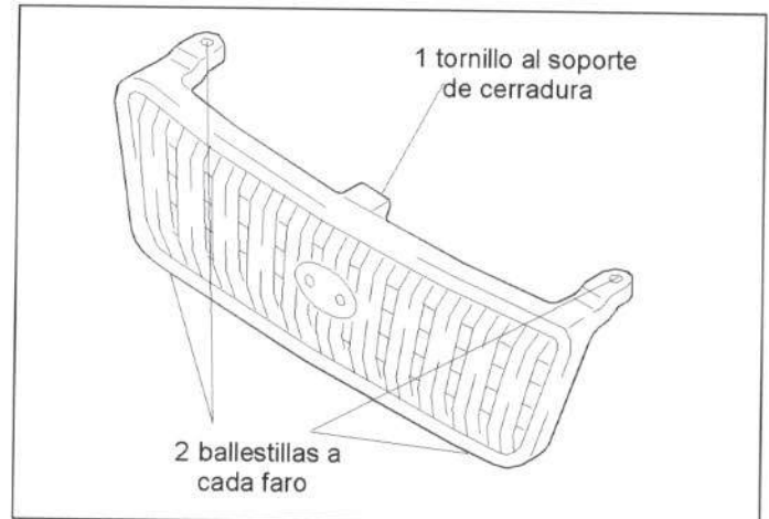
Figura 19.- Unión de la rejilla frontal
