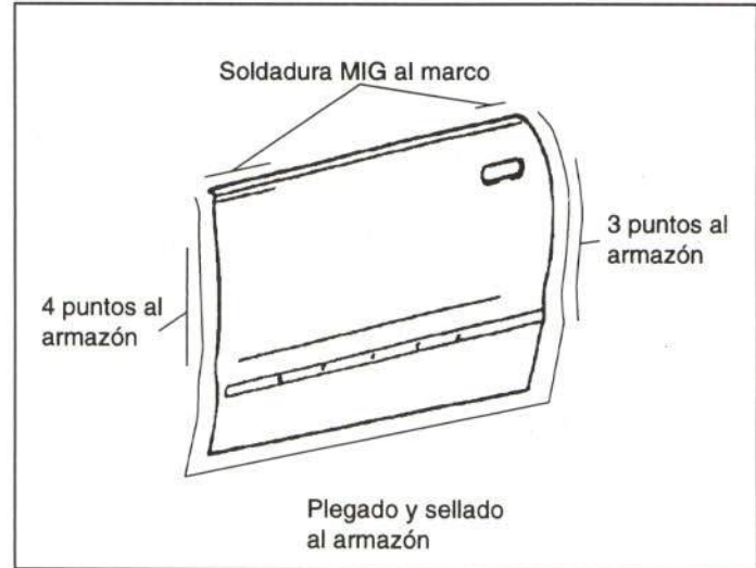
Figura 31.- Unión del panel de puerta delantera
