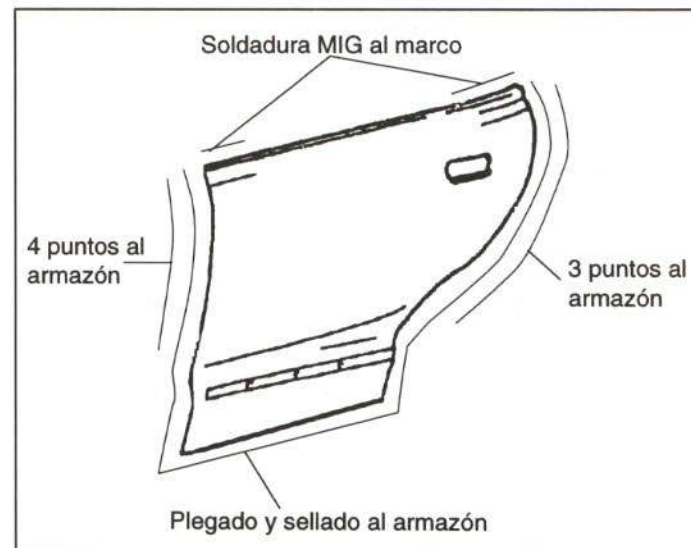
Figura 34.- Unión del panel de puerta trasera
