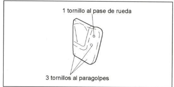
Figura 44.- Unión del guardabarros
