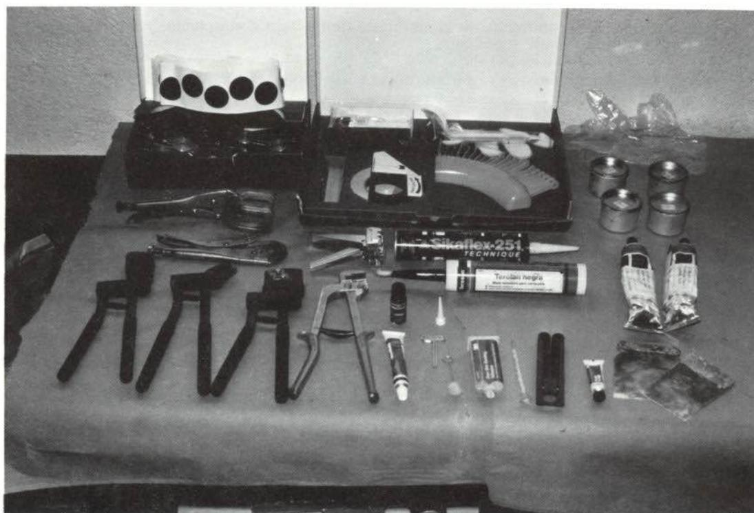
FIGURA 1.—Uillaje diverso para la aplicación de adhesivos en el pegado de metales.
