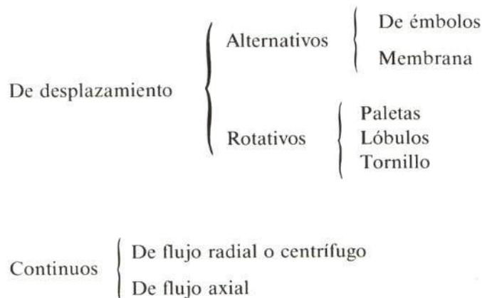
En un taller de reparación se utilizan fundamentalmente dos tipos: los de ciclo alternativo o de pistón y los de ciclo rotativo de paletas.
