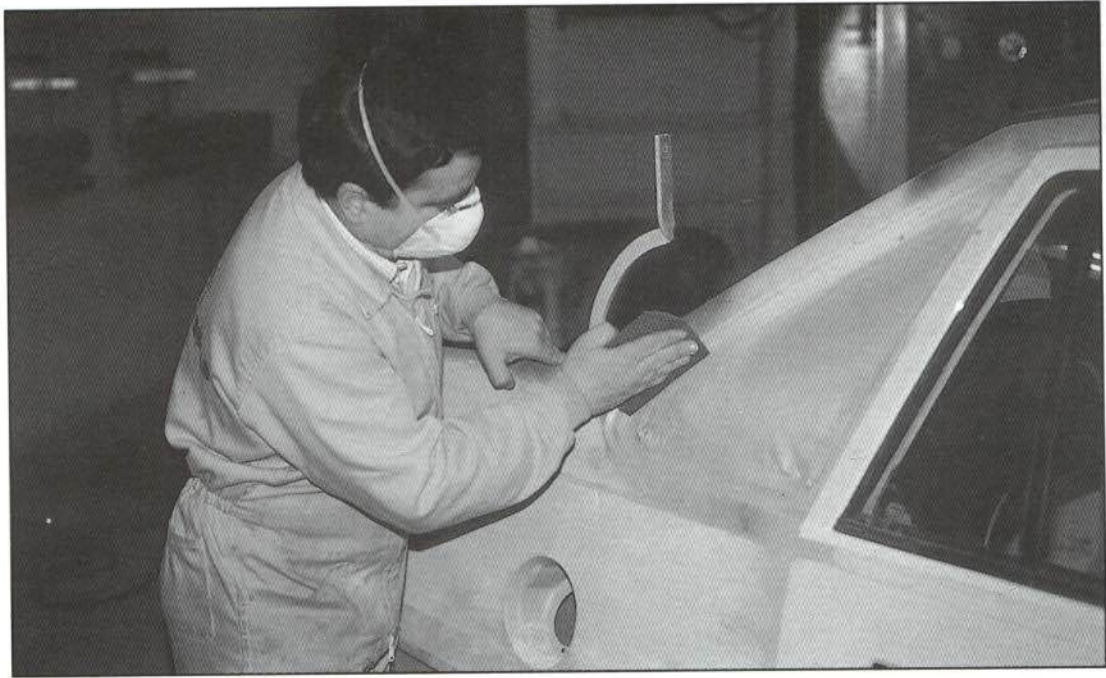
FIGURA 4.—Lijado manual con almohadilla abrasiva.
