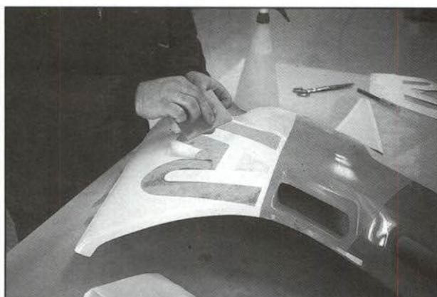
FIGURA 6.—Colocación de adhesivos.
