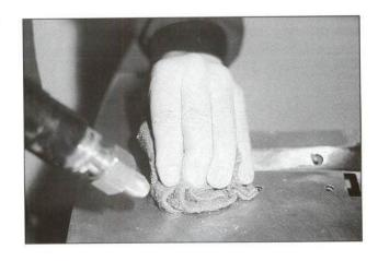
2.17. Suavizado del panel para eliminar las tensiones creadas por el tratamiento térmico.
