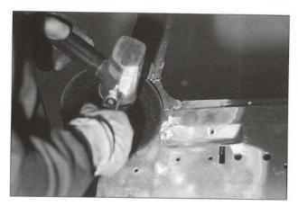
2.12. Las deformaciones que aún persisten se recuperan con mazo de madera y palanca.
