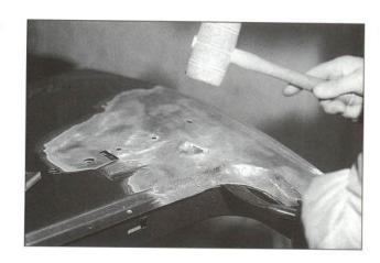
2.13. Batido de la zona con tas y martillo para resolver las deformaciones que no se pueden controlar con el mazo de madera.
