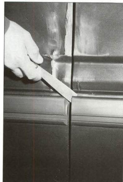
2.3. Tirando a la vez de las dos empuñaduras del hilo, y llevándolo paralelo a la carrocería, se realizará el corte del adhesivo.
