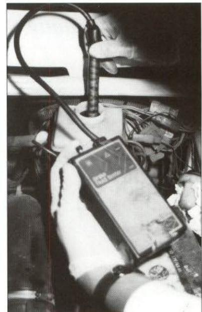
Figura 2.—Comprobación de la humedad del líquido de frenos.
