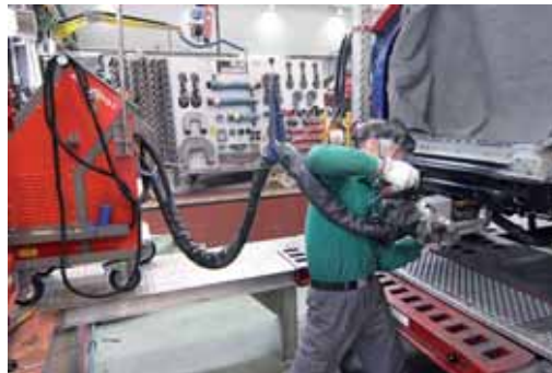
► Soldadura de un faldón trasero
