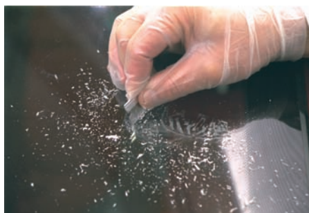
► Eliminación del material sobrante
