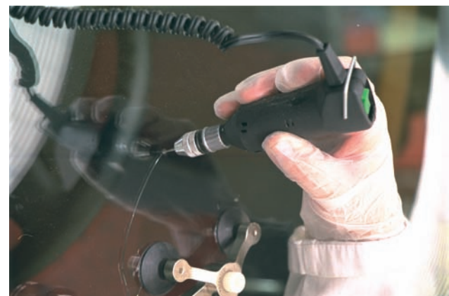
■ Taladrado de los bordes de la fisura
