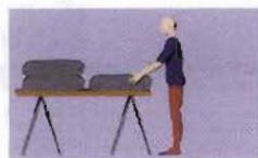
Figura 84 - Soporte para colocar sacos.
