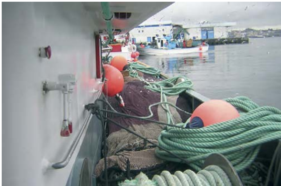
La acumulación de los aparejos y las artes de pesca en cubierta dificulta la circulación por la misma y hace inútil la existencia de amuradas.
