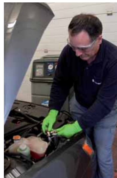
► Manipulación del aire acondicionado
