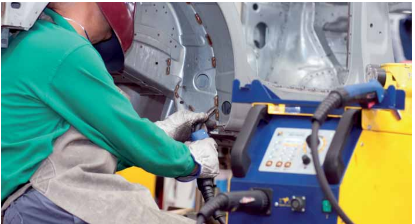
► Soldadura con el equipo Duogys Auto
