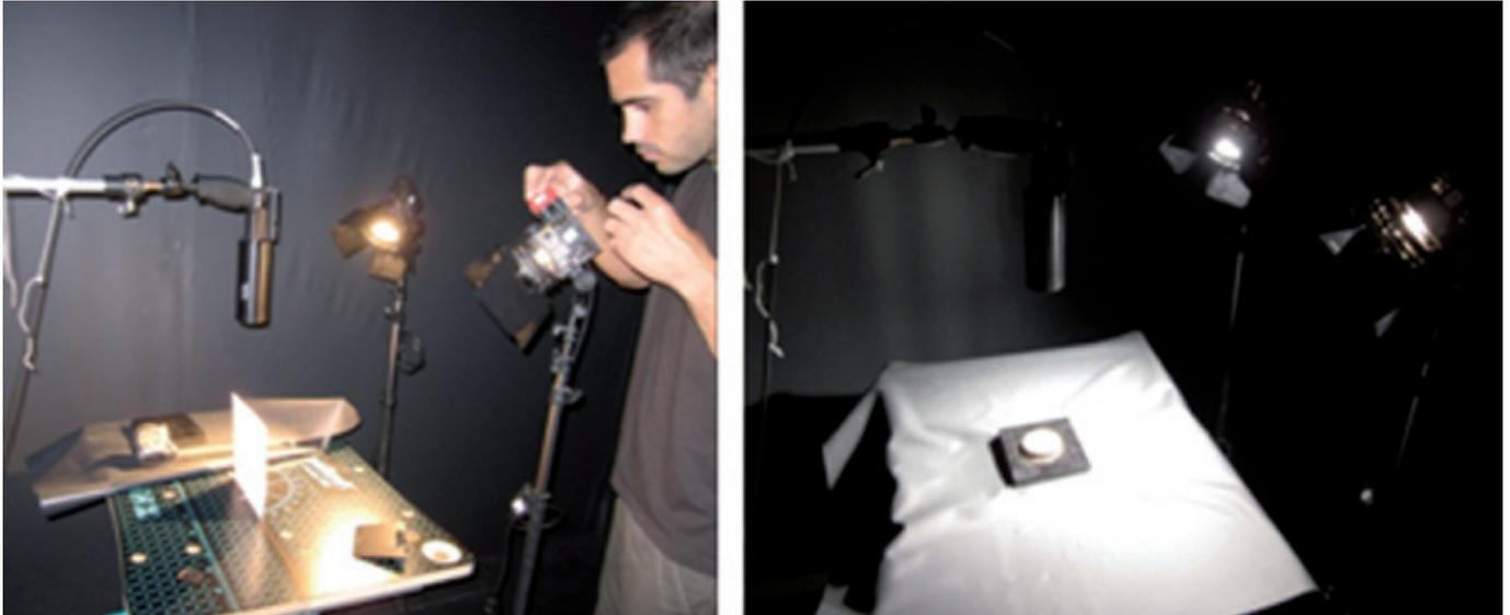
Figura 3. Preparación y montaje del laboratorio para las mediciones de reflectividad con el radiómetro ASD.
