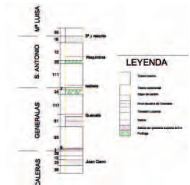
Figura 94. Columna estratigráfica del Pozo Barredo
