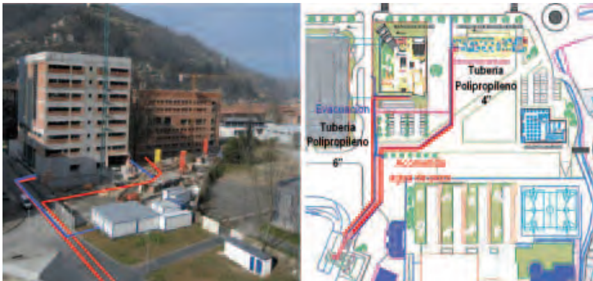
Figura 105. Esquema del sistema de distribución (cortesía de HUNOSA)
