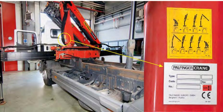
▶ Placa de fabricante de grúa de autocarga
