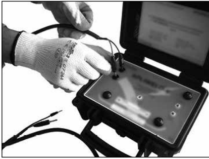
Figura 7. Conexión de los dos pares de bananas al equipo de encendido
