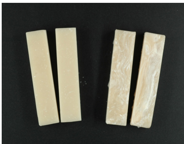
Figura 1. Probetas de cemento óseo base preparadas antes de seguir el protocolo descrito (probetas de la derecha) y tras el protocolo descrito (probetas de la izquierda)
