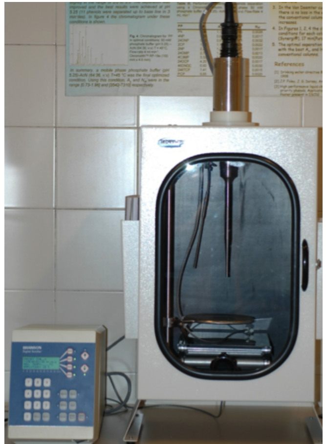
Figura 3. Equipo de sonicación utilizado en la dispersión de los nanotubos de carbono
