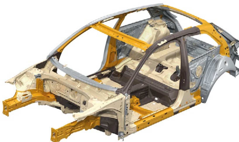
► Tipos de aceros en la estructura de la carrocería del Audi A3
