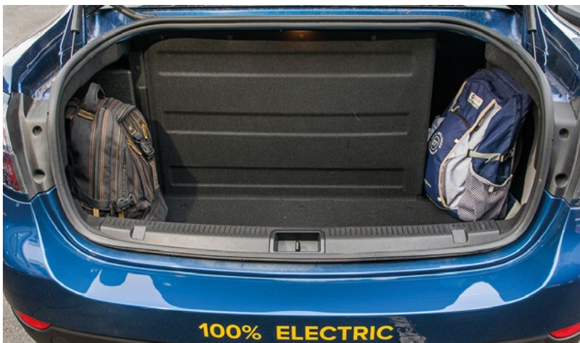
► Maletero del Renault Fluence Z.E, con la adaptación para alojar las baterías
