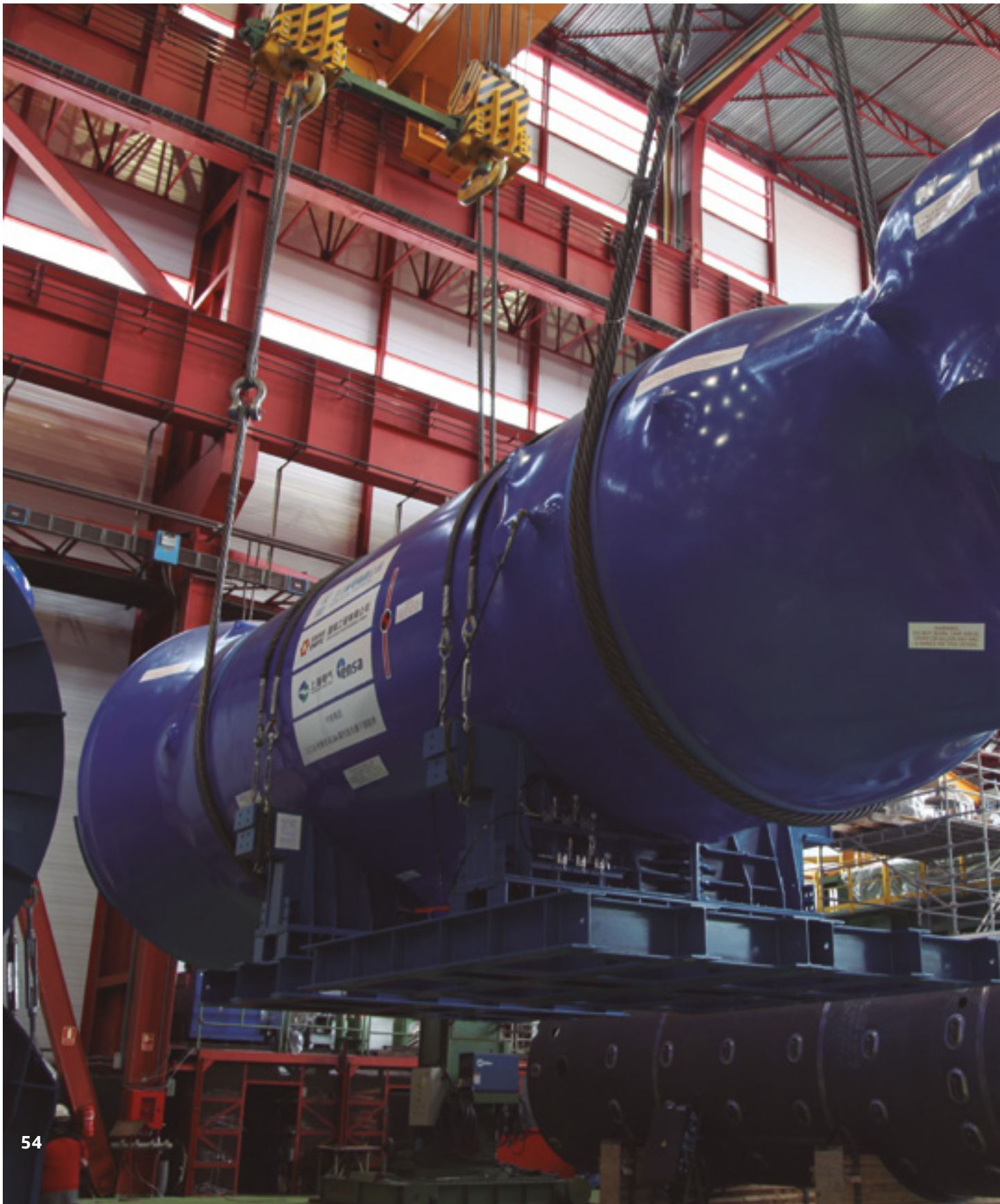
Embarque generadores de vapor
