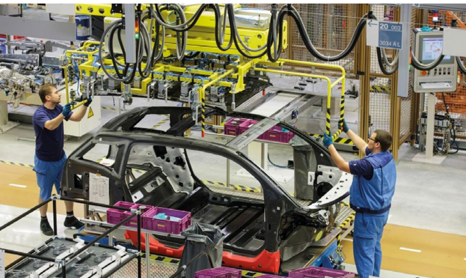
► Fabricación de carrocería de fibra de carbono
