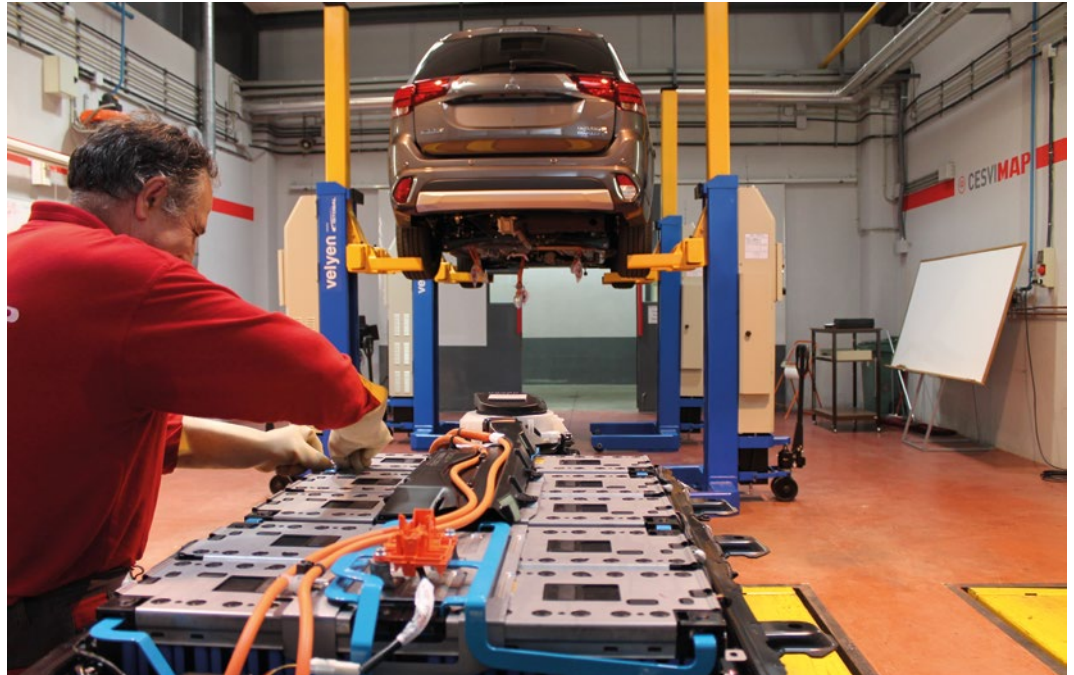
► Intervención sobre la batería
