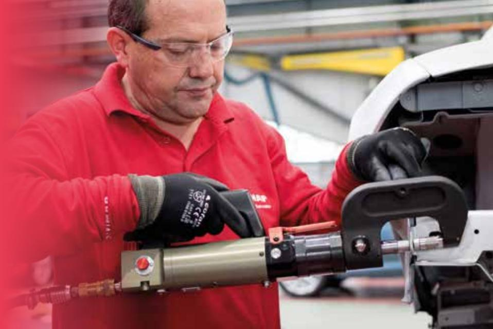
El equipo de remachado Gyspress 8T es de **accionamiento neumático**. Está indicado para extraer los remaches colocados en la carrocería, en su fabricación, y ensamblar remaches en la unión de piezas metálicas de acero y aluminio.
