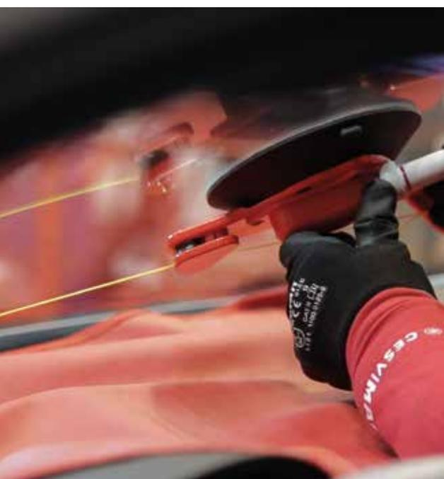
Por la parte interior se fija firmemente el hilo al eje del útil.
