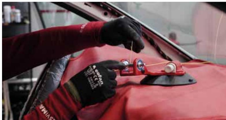
► Fijación del hilo al eje del útil
