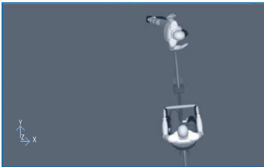
FIGURA 2. Simulación realizada con MADYMO® para analizar una colisión fronto-lateral entre un ciclista (varón, percentil 50) y una peatona (mujer, 5 percentil)
