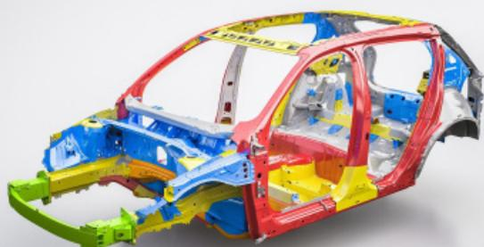
sí misma y a todos los conjuntos mecánicos, con una estructura más rígida, estable y ligera. Generalmente monocasco, está formada por un gran número de piezas de chapa unidas con puntos de soldadura y adhesivos. Solo algunas, como puertas, portones, aletas delanteras, frentes y en algunos casos, las aletas traseras, van ensambladas mediante tornillos. Este sistema facilita enormemente su reparación, sustitución o pintado.
