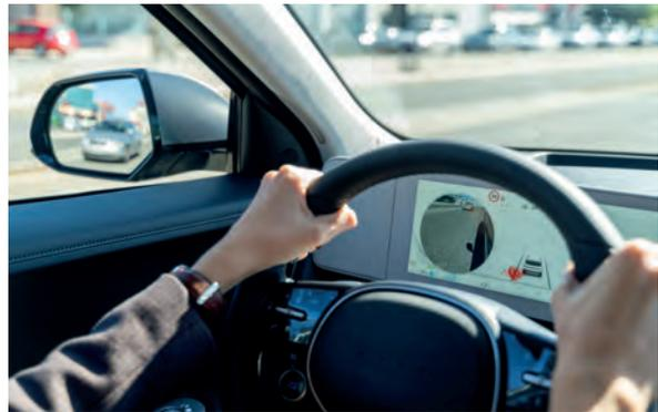
Visión lateral del vehículo al accionar el intermitente
