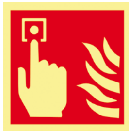
Pulsador de alarma
