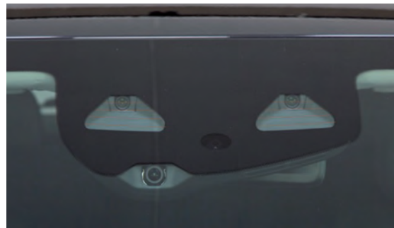
Ubicación de las cámaras en la parte superior del parabrisas
