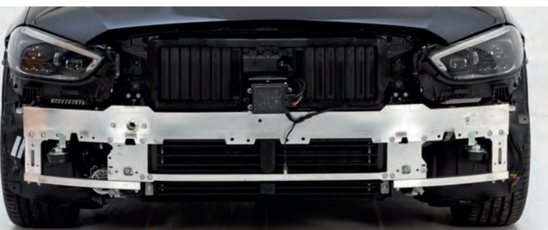
Ubicación del radar en la parte superior de la traviesa delantera
