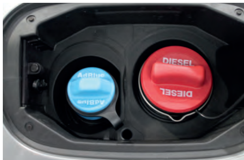
Sistema Adblue en vehículos diesel
