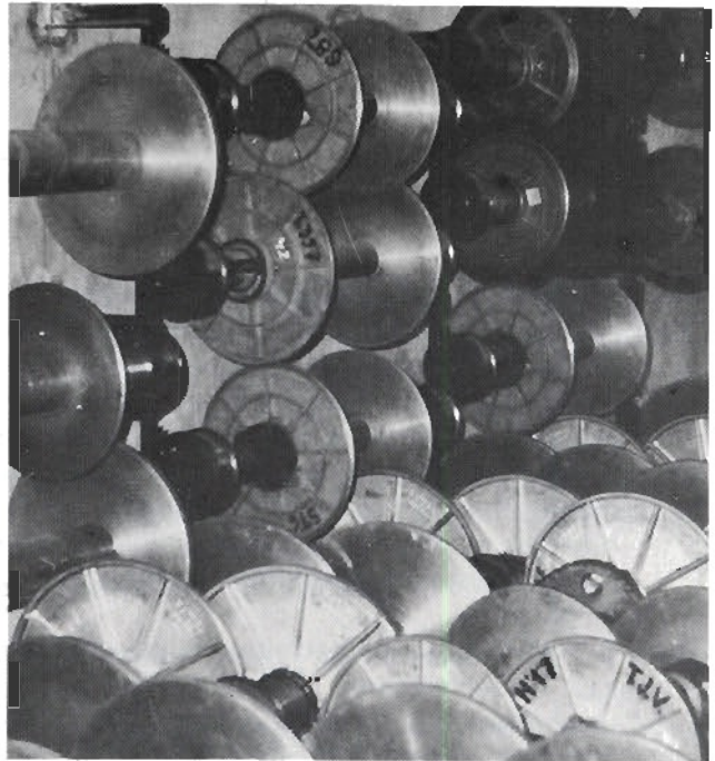
Figura 5. Almacenamiento de plegadores
