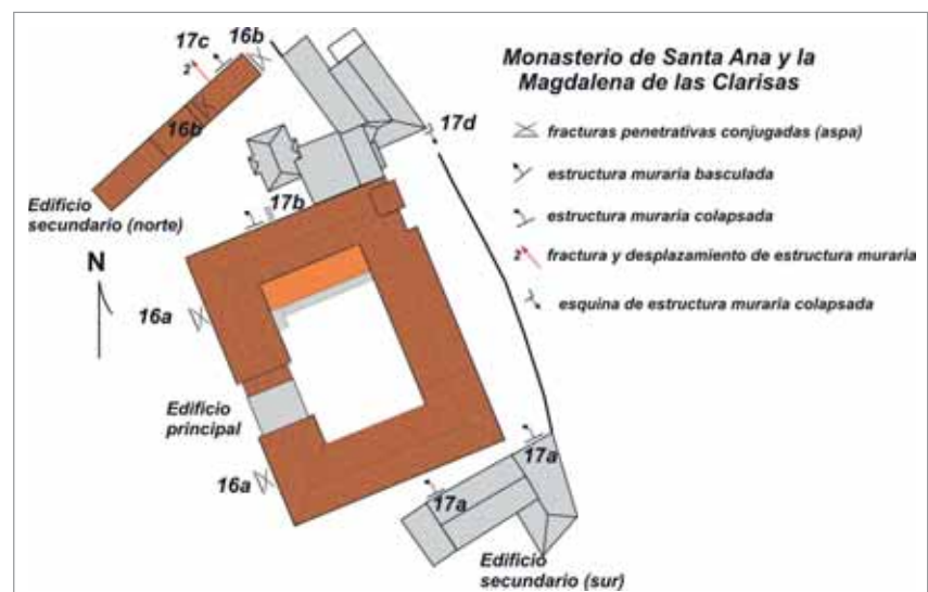
Figura 17. Resultados del análisis de los daños en el monasterio de las Clarisas. La caracterización de la cinemática y de la orientación de los daños nos permite sistematizar la toma de datos y su representación para su posterior análisis. En el caso de este edificio histórico, los resultados muestran que los daños presentan una clara orientación según N140°E, incluso el sentido de los colapsos en muros de diferentes edificios del convento es homogéneo según 320°, orientación que se repite en la práctica totalidad de los edificios históricos afectados por este sismo.
